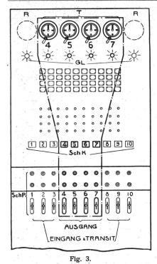
Signal und Schlußklappe. Beim Erscheinen des Warnungs-Signales oder der Schlußklappe hat die Telephonistin somit ohne weitere Überlegung den zugehörigen Sprechschlüssel zu ziehen.
