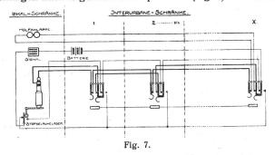
Diese Schaltung erleichtert den Verbindungsleitungsbetrieb immerhin wesentlich; dabei ist zu bemerken, daß infolge Verbesserung der Konstruktion der Stöpselruhelager Störungen auf ein Minimum reduziert werden konnten.
