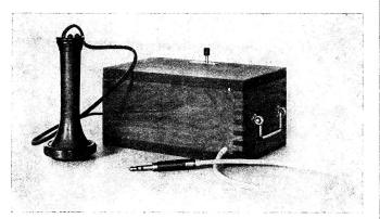
cette boîte est munie d'une poignée qui en facilite le transport, d'un récepteur relié à la boîte au moyen d'un cordon, d'un second cordon terminé par une fiche et d'un bouton servant à mettre le vibrateur (Fig. 2.) en mouve-
