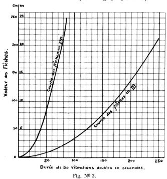
Exemple d'application. Nous voulons mesurer la flèche d'un fil. Nous constatons à l'aide du chronographe ou de la montre ordinaire que la durée de 10 vibrations doubles comptées sur le fil est de 16 secondes. La durée de 30 vibrations doubles est alors de 48 secondes. Le graphique
