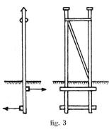
l'assemblage des poteaux, il doit être suffisamment solide pour que les deux faces du quadrilatère, parallèles à la direction de la traction unilatérale, forment deux poutres indéformables. L'effort fléchissant se répartissant sur ces deux faces, chacune de cellesci doit être à même de supporter une traction horizontale de 1800 kg au centre du chevalet. Pour solidariser complètement les deux poteaux
