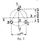
en flexion plane, passe par le centre de gravité du triangle. Ce centre de gravité se trouve être le centre du cercle inscrit ou du cercle circonscrit au triangle (voir fig. 1). Il est au  $^{1}/_{3}$  de la médiane A D à partir de B C, la base. Le moment d'inertie 1) du système est par rapport à l'axe
