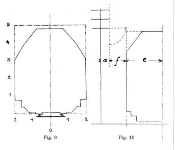
voie, la flèche maximale f du fil et l'écart minimal e demandé entre l'axe de la voie et l'objet le plus rapproché (voir fig. 10); de sorte qu'on a
