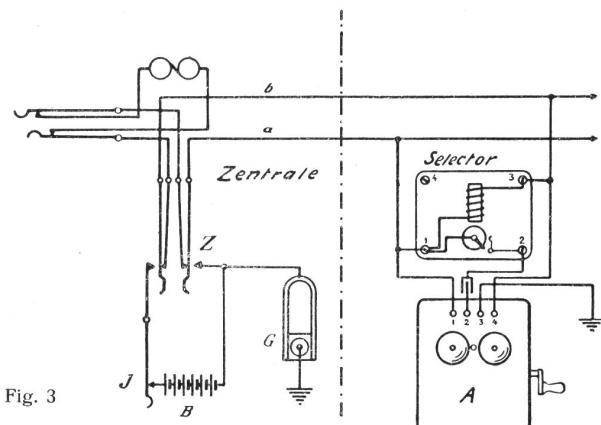
Bei den zum Betrieb mit Selectoraufruf verwendeten Telephon-Stationen ist der Wecker unabhängig vom Hauptstromlauf der Station an zwei Klemmen 2 und 3 (Fig. 3) angeschlossen. Klemme 2 wird über einen 2Mf. Kondensator mit der Klemme 2 des Selectors, Klemme 3 des Telephon-Apparats mit der Erde verbunden. Draht a der Schleife ist an die Selector-klemme 1 angeschlossen.
