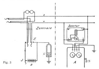
Bei den zum Betrieb mit Selectoraufruf verwendeten Telephon-Stationen ist der Wecker unabhängig vom Hauptstromlauf der Station an zwei Klemmen 2 und 3 (Fig. 3) angeschlossen. Klemme 2 wird über einen 2Mf. Kondensator mit der Klemme 2 des Selectors, Klemme 3
