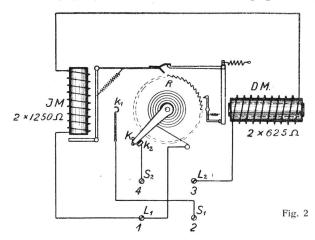
JM wirkt durch den mit dem Anker verbundenen Schalthaken auf das gezahnte Kontaktrad R, dessen Kontaktarm K in der Ruhestellung infolge einer an der Achse befestigten Spiralfeder auf einem festen, an der Aufliegestelle isolierten Anschlag k2 ruht. Dieser Anschlag, welcher konzentrisch zur
