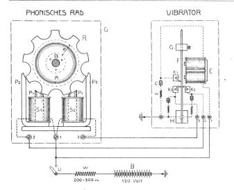
Widerstand von je 440 Ohm (7800 Umwindungen von 0,18 mm Kupferdraht mit Seidenisolation); sie sigen auf einem Gußsockel, der zugleich die Grundplatte für das Verteilergehäuse bildet und auf einem breiten Holzsockel mit Filzunterlage ruht. Zur Aufnahme der äußern Verbindungen dienen 4 Anschlußklemmen, wovon 3 für den Phonischen Motor und 1 für die Erdverbindung des Korrektionssystems benützt werden.
