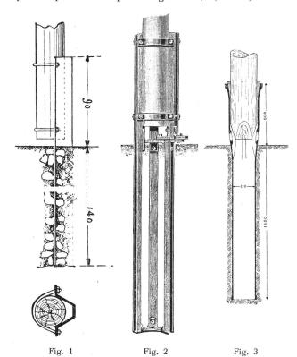
poids de ce socle est d'environ 60 kg. Avant la guerre il coûtait de frs. 36.50 jusqu'à frs. 40.80, suivant le numéro, sans les frais de transport. Son emploi est donc très coûteux. De plus, ce socle n'a pas une surface suffisante en terre. Dans un sol végétal par exemple, il faudrait noyer les trois fers ☐ dans une base en béton, sinon la terre ne supporterait pas la forte pression des fers ☐.
