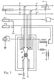
sie in dessen Ruhelage normal geschaltet sind (Figur 1). Wird der Schalter nach V umgelegt, so werden der Tund R-Leiter der Schnur isoliert, S dagegen über ein 1000 - Ohm - Relais mit Erde und parallel dazu über einen Kondensator mit dem Summer-Transformator T T verbunden.
