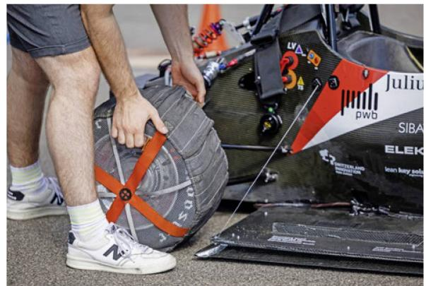
ARRIBA: Montaje de los neumáticos precalentados. Bajo el vehículo se ve el dispositivo de succión.
