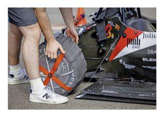
ARRIBA: Montaje de los neumáticos precalentados. Bajo el vehículo se ve el dispositivo de succión.
