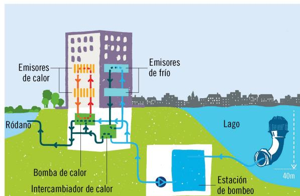
El proyecto de hidrotermia persigue dos objetivos. En invierno, una bomba de calor extraerá la energía del agua para calentar un edificio. En verano, será posible climatizarlo con agua fría procedente de las profundidades del lago.
