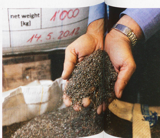
Materiales como el cobre, el aluminio o también el oro se extraen de la criba de la escoria de plantas de incineración de basuras
