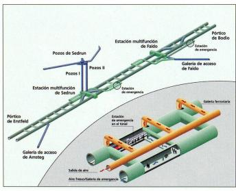
Esquema del túnel de base del Gotardo, con paradas de emergencia y ventilación.
