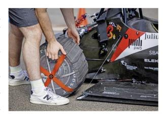
OBEN: Die temperierten Reifen werden montiert. Erkennbar ist der Saugapparat unter dem Auto.
