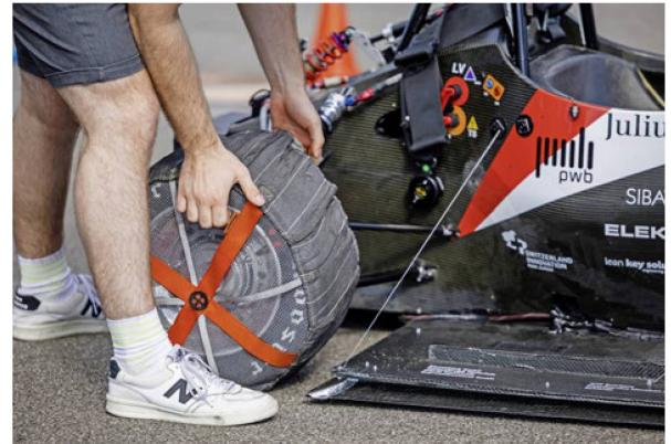
OBEN: Die temperier- ten Reifen werden montiert. Erkennbar ist der Saugapparat unter dem Auto.
