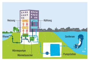
Das Genfer Hydrothermie-Projekt zielt auf einen doppelten Nutzen. Im Winter wird dem Wasser mithilfe einer Wärmepumpe Energie entzogen, um ein Gebäude zu heizen. Im Sommer kann mit kühlem Wasser, das aus der Tiefe entnommen wird, ein Gebäude gekühlt werden.
