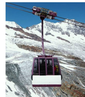
Auch diese Bahn steht für besondere Innovation: Die weltweit erste Luftseilbahn an drei Seilen schwebt seit 1991 in Saas Fee den Berg hoch. Foto Martin Arnold
