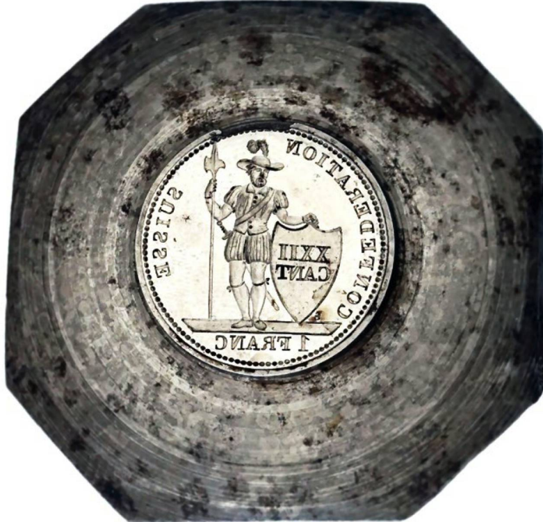
Stempel für die Stosswerkprägung einer Ein-Schildfranken-Münze. Kanton Waadt, Lausanne, 1846.
