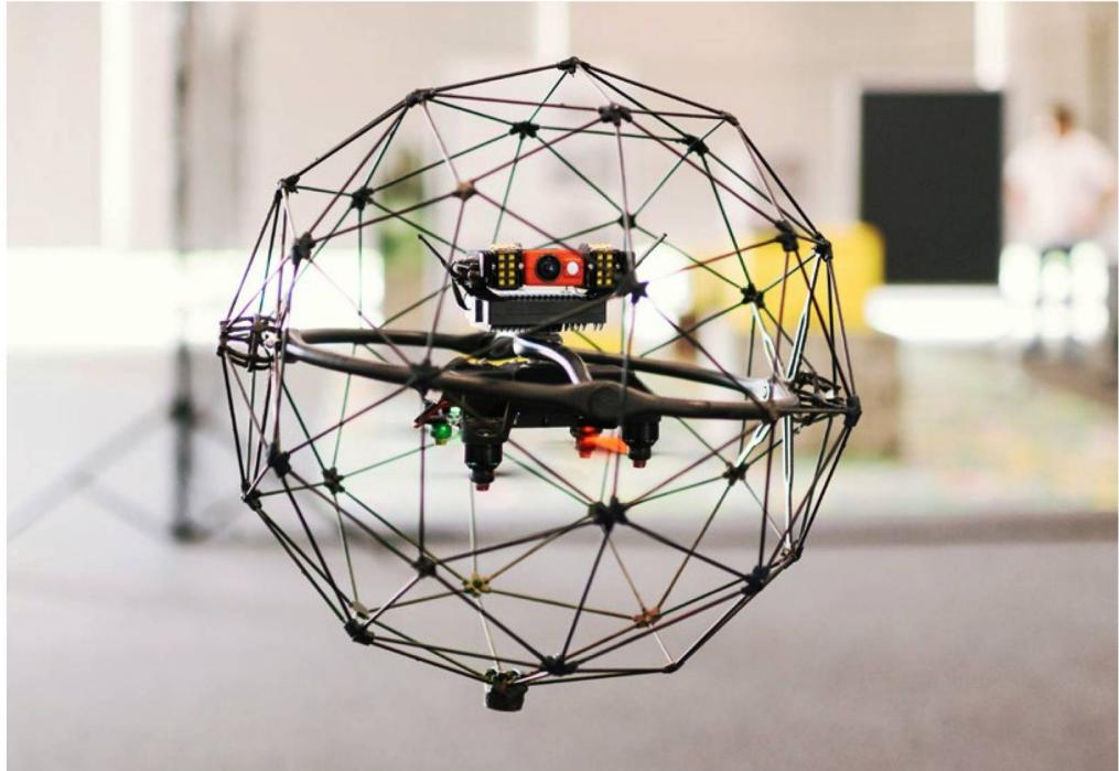
Kollisionen mit Hindernissen aushalten kann», sagt Marc Gundillon von Flyability. Das «Flaggschiff» des westschweizerischen Unternehmens mit 30 Mitarbeitenden heißt Elios. Es zeichnet sich durch einen besonders flexiblen und leichten Rumpf aus. Das
