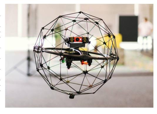
Kollisionen mit Hindernissen aushalten kann», sagt Marc Gandillon von Flyability. Das «Flaggschiff» des westschweizerischen Unternehmens mit 30 Mitarbeitenden heisst Elios. Es zeichnet sich durch einen besonders flexiblen und leichten Rumpf aus. Das
