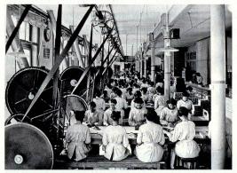
Kemptthal, 1896: Fliessbandarbeit in der Maggi-Fabrik. Vor der Elektrifizierung erzeugten mechanische Transmissionseinrichtungen die Fliessbandbewegung für das Abpacken
