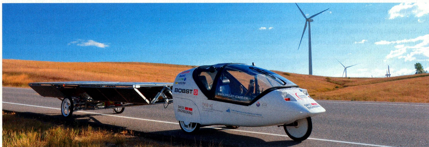
Das umfunktionierte Twike «Icarette» wird mit Sonnenenergie und Windkraft angetrieben
