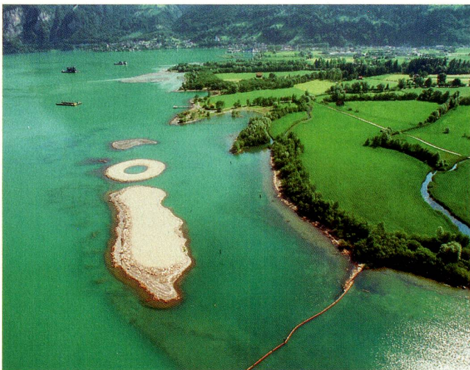
Aufschüttung mit Aushub aus dem Gotthard im Reussdelta vor Flüelen.
