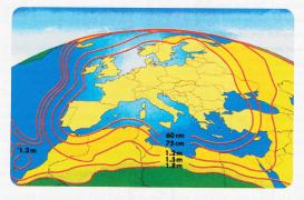
Für den Empfang der Signale von Hotbird 3 benötigen Sie eine digitaltaugliche Satellitenantenne mit mindestens 60 cm Durchmesser und Universal-LNB (Empfangskonverter). Die Grösse der Parabolantenne in Ihrem Empfangsgebiet können Sie der Karte entnehmen.
