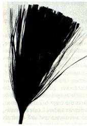
hängt werden. Unser Bild zeigt das aufgefaserte Ende eines sechs Millimeter dicken Drahtes, der aus einer halben Million Kohlenstoff-Fasern besteht. Je 400 dieser Drähte würden ein Tragkabel der Hängebrücke bilden (Foto: EMPA).
