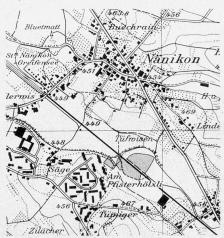
nen und kleinsten Elementen zur Folge. Um die damit verbundene Unleserlichkeit der Karten zu verhindern, muss jeder Massstab kartographisch vollständig neu bearbeitet werden. Dabei ist der Bildinhalt mit kleiner werdendem Massstab zunehmend zu vereinfachen, mehrere gleichartige beisammenliegende Elemente, z.B. Häuser, sind zusammenzufassen, Unwesentliches ist wegzulassen und Wesentliches hervorzuheben. Man nennt dieses graphische Selektions- und Abstraktionsprinzip «Generalisieren»
