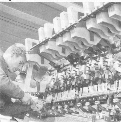
Montage d'une batterie de contacteurs électropneumatiques Het monteren van een batterij elektropneumatische contactoren.
