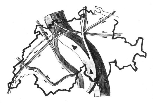
Der St. Gotthard, eine wichtige Verbindung zwischen EG-Ländern. Die Bedeutung dieses Nord-Süd-Verbindungsweges, der im Jahre 1240 eröffnet wurde, ist heute offensichtlich. Die Breite der eingezeichneten Linien zeigt die Zugdichte an. Auf der St. Gotthardlinie verkehren täglich 200-300 Züge. Letztere Zahl stellt den Sättigungspunkt dar. Hieraus ergibt sich die Notwendigkeit der Errichtung eines zweiten Tunnels.
