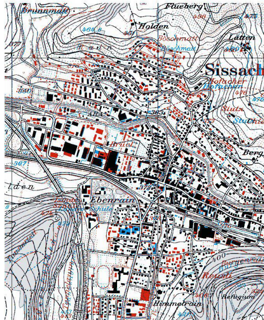
Abb. 11: Die Differenzkarte zwischen den Nachführungsständen 2006 (rot) und 1988 (blau) zeigt das Prinzip, das Veränderungen auf einen Blick sichtbar macht und unveränderte Elemente grau belässt.
