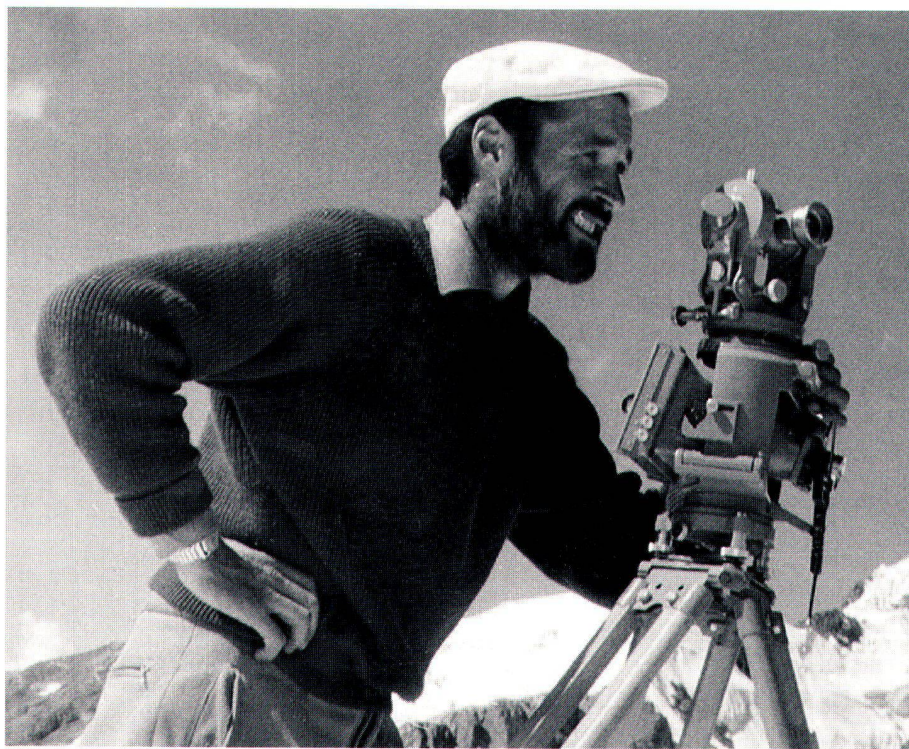
Abb. 8: Der Autor bei Winkelmessungen und Phototheodolitaufnahmen auf der Basis Cerro Central. Der einheimische Messgehilfe hat sich hier erstmals als Photograph betätigt.
