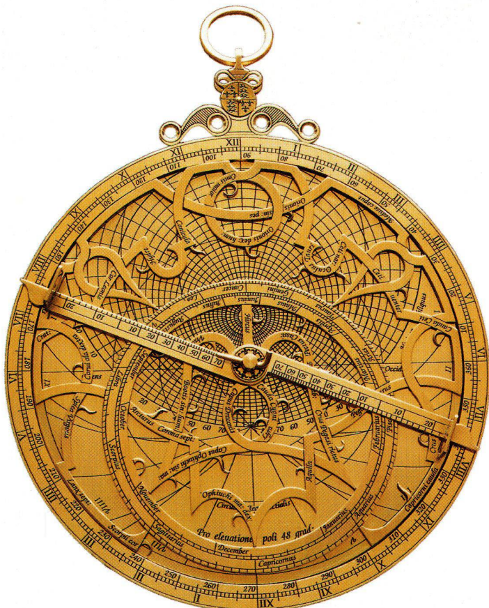
Abb. 1: Arsenius-Astrolabium, um 1550, Vorderseite. Messing-Nachbau, Durchmesser 157 mm.
