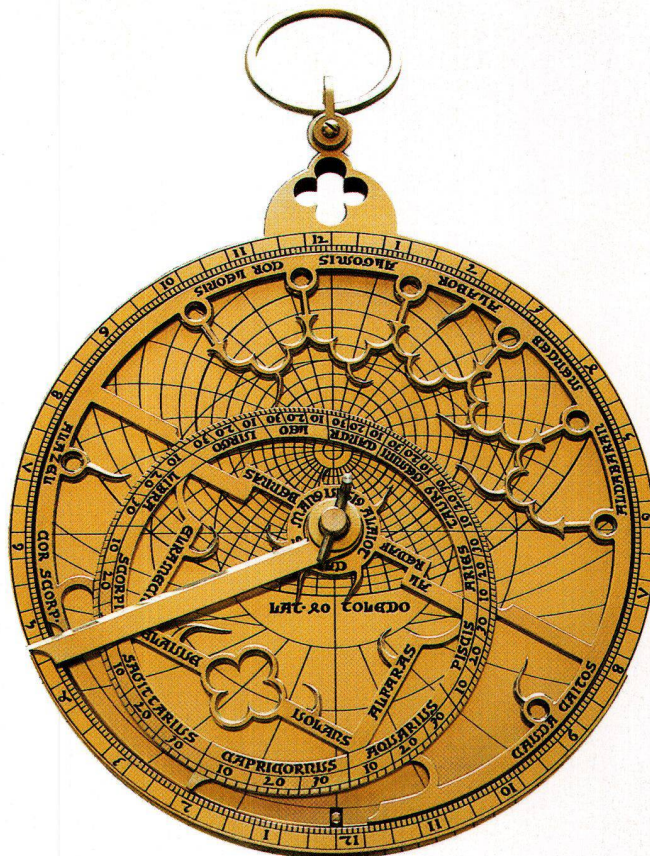
Abb. 2: Spanisch-gotisches Astrolabium. 14. Jahrhundert, Vorderseite. Messing-Nachbau, Durchmesser 120 mm.
