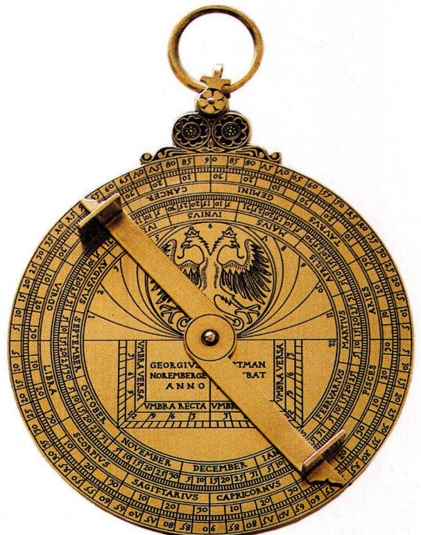
Abb. 6: Hartmann-Astrolabium, Nürnberg 1531. Rückseite mit Ekliptik- und Kalenderkreis. Im Zentrum das Schattenquadrat (unten) und das Diagramm der ungleichen Stunden (oben). Über der Rückseite dreht sich die Alhidade mit Diopter. Messing-Nachbau, Durchmesser 100 mm.
