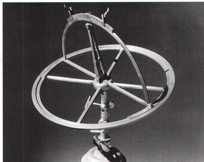
Abb. 8: «Universalgerät», von Peter Anich gebaut. Instrument zum Messen von Horizontal- und Vertikalrichtungen. Der Horizontalvollkreis (Durchmesser ca. 36 cm) mit dem aufgesetzten Höhenhalbkreis (Radius 16,5 cm) erlaubt das Ablesen der Richtungen auf jeweils 1 Winkelminute. Die Zieleinrichtung, vermutlich ein am Höhenhalbkreis zu befestigendes, abnehmbares Zielfernrohr fehlt (Photo: Archiv Arthur Dürst, Zürich).
