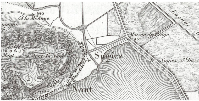
Abb. 58: Ausschnitt aus Blatt II der Kantonskarte 1:50 000 mit den Signaturen für die Vegetationsdarstellung wie Einzelbäume bei Strassenalleen, Reben, Sumpf und Wald. Zudem ist der Endpunkt der Basismessung im Grossen Moos zwischen Walperswil und Sugiez eingetragen. Abbildung auf ca. 150% vergrössert.
