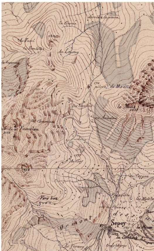
Abb. 13: Musterzeichnung für die Dufourkarte, Blatt XVII. Subdivision 1 im Massstab 1:50 000, um 1841. Farbige Tuschezeichnung von Stryieſki, Format: 70 x 48 cm. Mit diesem Versuch wollte Dufour die Wirkung der angestrebten Felsdarstellung und der Schattenschraffen testen. Vielleicht diente diese Musterzeichnung auch als Vorlage für den Kupferstecher (swisstopo Kartensammlung, TKZ Studien 17 1).
