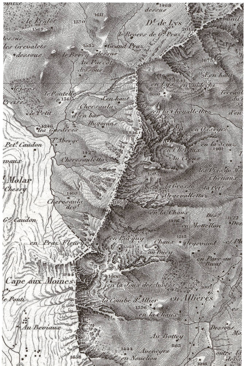
Abb. 61: Ausschnitt «Cape aux Moines» aus Blatt III. Auf der Freiburgerseite sind rechts der Krete und nördlich Pt. 1658 einige Bergsturzböcke erkennbar. Für das ausserkantonale Waadtländer Gebiet wurde die Topographie nur mit horizontalen Geländeformlinien und einer rudimentären Felszeichnung wiedergegeben. Beim Namen en Praz Fleury ist noch ein Rest der unteren Hilfslinie für den Schriftstecher zu erkennen. Im oberen Teil der Abbildung sind in den flächenhaften, eng gescharten Geländeschraffen die Lokalnamen und Höhenzahlen nicht immer gut lesbar. Deshalb schlug Stryienski bei der Durchsicht der Zustandsdrucke dem Schriftstecher vor, in solchen Bereichen die Schrift freizustellen und die Buchstaben und Zahlen nur mit einem feinen Punktraster zu unterlegen (z.B. Chenalletta ). Abbildung auf ca. 140% vergrössert.
