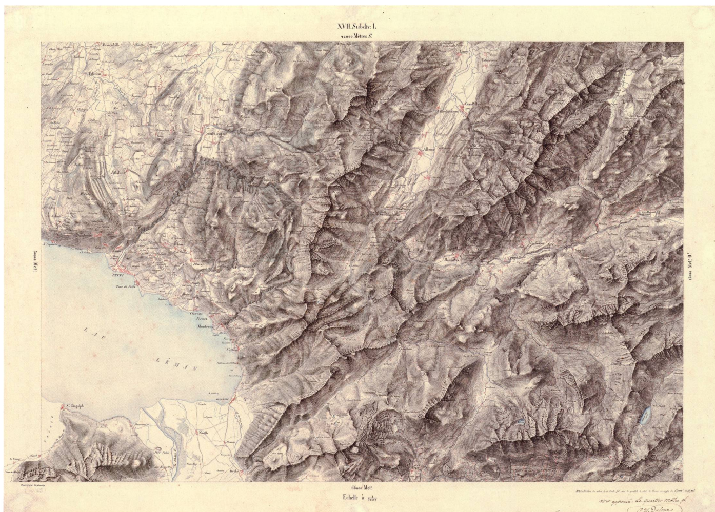
Abb. 13: Musterzeichnung für die Dufourkarte, Blatt XVII. Subdivision 1 im Massstab 1:50 000, um 1841. Farbige Tuschezeichnung von Stryieſki, Format: 70 x 48 cm. Mit diesem Versuch wollte Dufour die Wirkung der angestrebten Felsdarstellung und der Schattenschraffen testen. Vielleicht diente diese Musterzeichnung auch als Vorlage für den Kupferstecher (swisstopo Kartensammlung, TKZ Studien 17 1).
