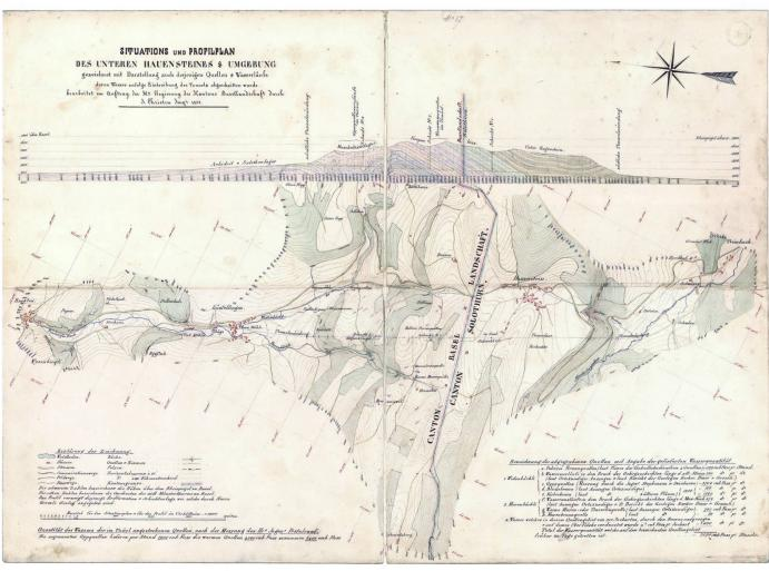
Abb.45 (links oben): Eisenbahn-Karte zwischen Basel–Olten, gezeichnet von Ingenieur Rudolf Gross, Verlag von Hasler & Cie Basel. Massstab 1:100 000, mit Längenprofilen der beiden Sektionen Basel-Sissach und Sissach-Olten in 1:66 666 / 1:10 000, je zwei Abbildungen von Brücken und Tunnelportalen sowie einem geologischen Längenprofil des Hauenstein-Tunnels. Mehrfarbige Lithographie, 41 x 28 cm (UBH Kartenslg Schw E 104. Online https://swisscollections. ch/Record/9961032760105504).
