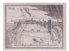
Abb. 6: Das Titelbild von Georg Friedrich Meyers Lehrbüchlein Trigonometria sive Doctrina Triangulorum – Die Lehr von aussmeßung der Triangeln, beschriben von Georg Friderich Meÿer Ing. A[nn]o MDCLXXVII. zeigt im linken Teil das Halbkreisinstrument auf einem Stockstativ zur Messung der Brechungswinkel in den Polygonzügen und darunter am Boden eine Messkette zur Messung der Distanzen (ETHBIB, Rar 4495. Online http://dx.doi.org/ 10.3931/e-rara-2947).
