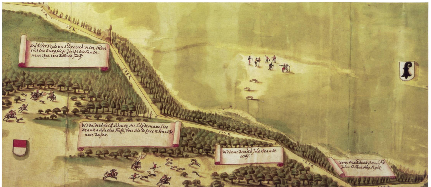
Abb. 5: Ausschnitt aus der 1620–1624 vorgenommenen Vermessung der Hoheitsgrenzen des Kantons Basel durch Hans Bock d. Ä. Der markante Baselstab zeigt das Basler Territorium mit den Fachleuten, die den Grenzverlauf diskutieren und mit dem Winkelmessgerät festhalten. Massstab ca. 1:4500, Tuschezeichnung, 224x30 cm (StABL, KP 5001 0036, Digitalisat online).
