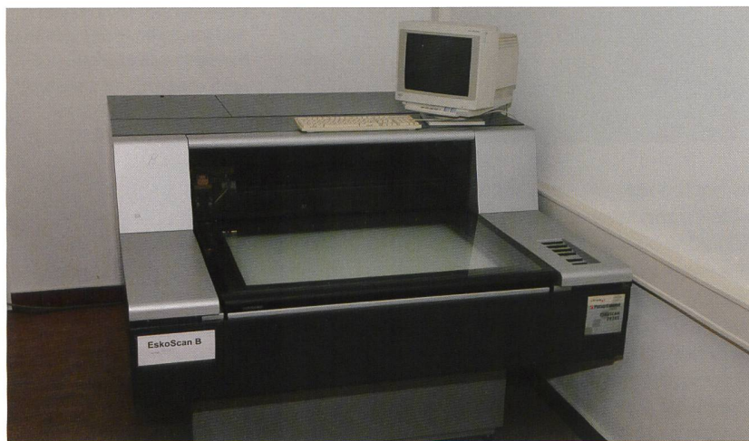
Abb. 5: 2001 wurde die analoge Klimsch Commodore-Kamera durch einen EskoScan 2636s-Flachbettscanner ersetzt, mit dem sich unter anderem auch die Originalglasplatten digitalisieren liessen (swisstopo).
