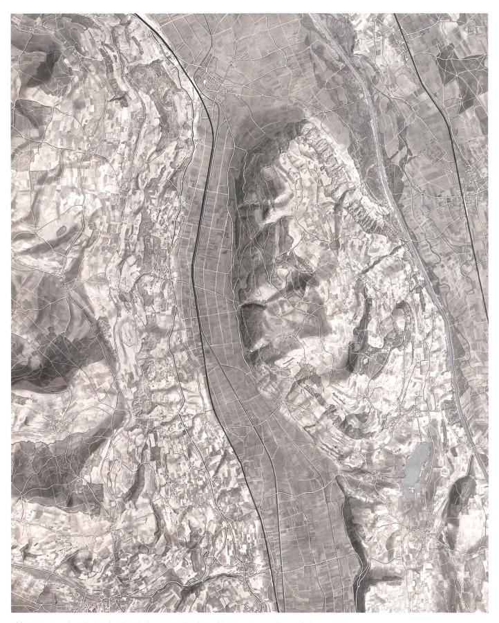
Abb. 46: Kartenprobe Belp – Gürbetal – Münsingen 1:25 000 als Kombination entzerrter Fliegeraufnahmen mit linearen Kartenelementen und Reliefton. Diese Karte belegt, dass nach Möglichkeiten gesucht wurde, um die ersten Aerophoto-Karten aus den 1930er-Jahren graphisch zu verbessern und lesbarer zu machen. Unikat: Papierkopie auf Aluminiumplatte, undatiert, um 1940, verkleinert auf ca. 55% (swisstopo, Kartensammlung).
