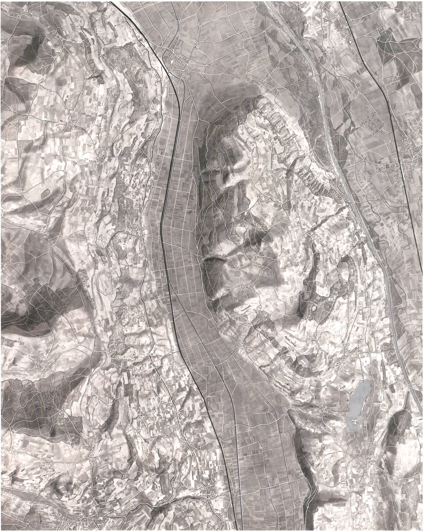
Abb. 46: Kartenprobe Belp – Gürbetal – Münsingen 1:25 000 als Kombination entzerrter Fliegeraufnahmen mit linearen Kartenelementen und Reliefkon. Diese Karte belegt, dass nach Möglichkeiten gesucht wurde, um die ersten Aerophoto-Karten aus den 1930er-Jahren graphisch zu verbessern und lesbarer zu machen. Unikat: Papierkopie auf Aluminiumplatte, undatiert, um 1940, verkleinert auf ca. 55% (swisstopo, Kartensammlung).
