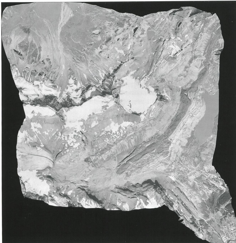
Abb. 52: Der gleiche Bildinhalt wie in Abb. 51 nach erfolgter differenzieller Entzerrung (Orthorektifikation). Jedes Bildelement (Pixel) liegt an seiner geometrisch korrekten Lage im Landeskoordinatensystem (swisstopo, Einzelbildorthophoto, Inv. Nr. 000-251-508).
