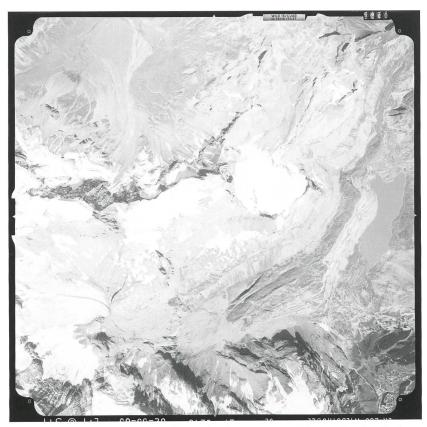
**Abb. 51:** Luftbild 23 x 23 cm im Originalzustand, aufgenommen am 2.9.1985 über dem Steghorn nordwestlich des Gemmipasses. Dieses Bild ist wegen der photographischen Zentralprojektion, der nicht genau senkrechten Lage der Bildachse und den grossen Höhendifferenzen innerhalb des abgebildeten Geländes stark verzerrt (swisstopo, Bildsammlung, Inv. Nr. 000-251-508).
