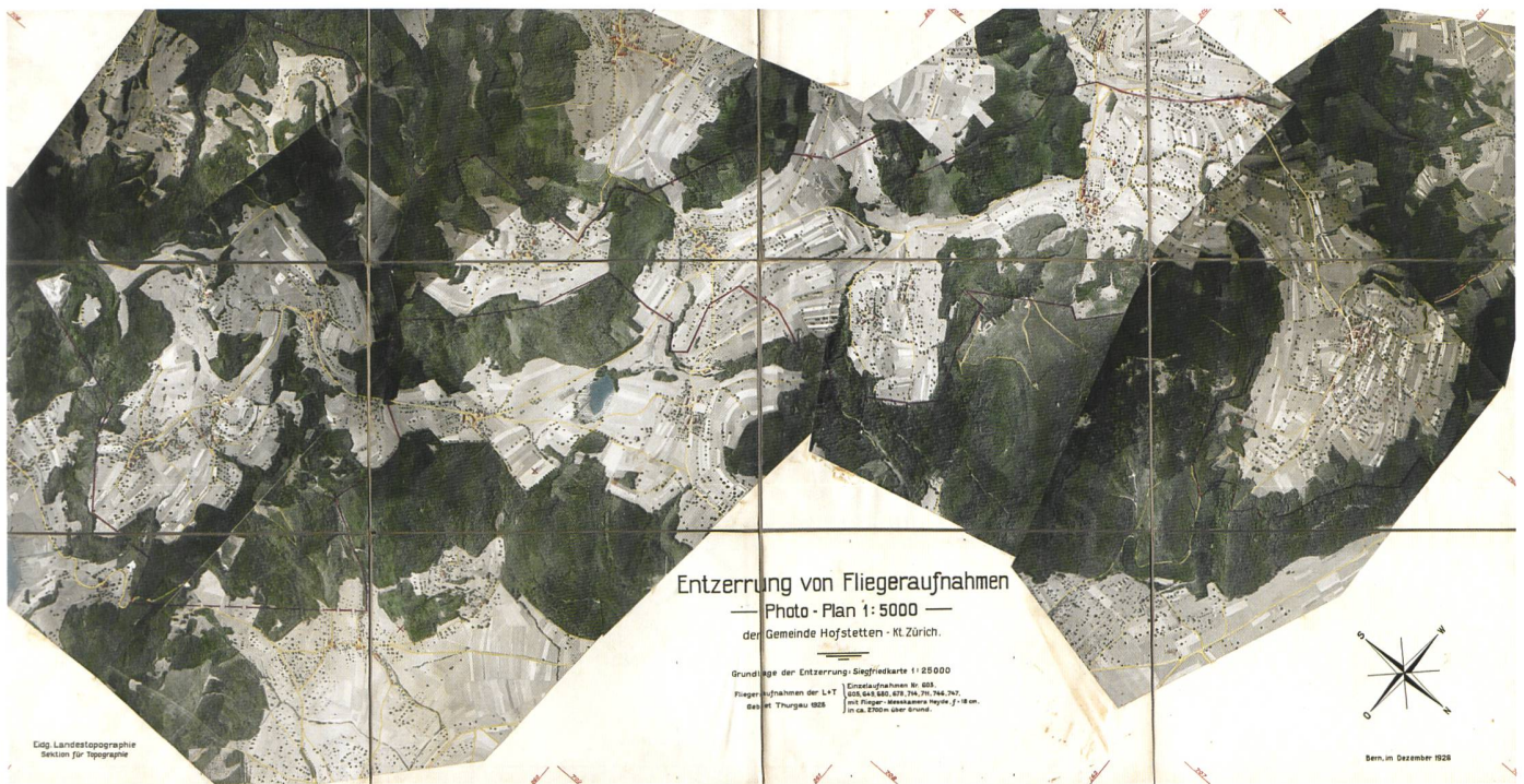
Abb. 37: Entzerrung von Fliegeraufnahmen. Photo-Plan 1:5000 der Gemeinde Hofstetten Kt. Zürich vom Dezember 1928, südwestorientiert, 150x78 cm, auf Leinwand aufgezogen, hier verkleinert auf ca. 15% (BAR E27/23234).
