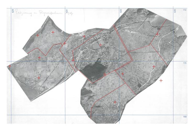
Abb.36: Bödeli, Interlaken 1:10 000. Entzerrung von Fliegeraufnahmen 1927. Papierbeschichtete masshaltige Aluminiumplatte mit aufgeklebten entzerrten Einzelbildern. Die hier ergänzten roten Schnittlinien zeigen die Begrenzungen der neun einzeln entzerrten Luftphotos aus dem Jahre 1926 (kleine Kreuze), mit blauem Koordinatengitter (Maschenweite 2 km) zur Sichtbarmachung der korrekten geometrischen Lage des Bildmosaiks (swisstopo, Kartensammlung).
