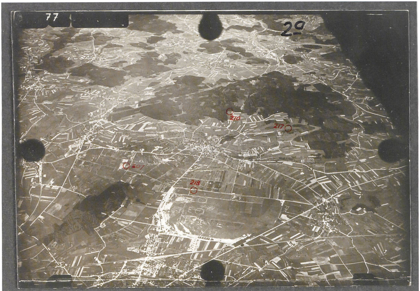
Abb. 33: «Luftmessbild 77», aufgenommen 1924 durch die Fliegertruppen mit einer Zeiss-Kamera mit einer Brennweite von 181.68 Millimetern aus 3367 Metern Meereshöhe auf eine Perutz-Spiegelglasplatte im Format 13 x 18 Zentimeter. Schrägaufnahme aus Richtung Südwest auf die Gemeinde Wangen bei Dübendorf (Bildmitte) und den Flugplatz (untere Bildhälfte, Mitte) (BAR, E27/22069#4#6).
