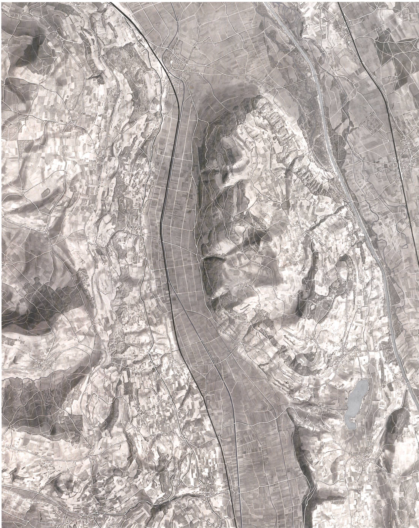
Abb. 46: Kartenprobe Belp – Gürbetal – Münsingen 1:25 000 als Kombination entzerrter Fliegeraufnahmen mit linearen Kartenelementen und Reliefton. Diese Karte belegt, dass nach Möglichkeiten gesucht wurde, um die ersten Aerophoto-Karten aus den 1930er-Jahren graphisch zu verbessern und lesbarer zu machen. Unikat: Papierkopie auf Aluminiumplatte, undatiert, um 1940, verkleinert auf ca. 55% (swisstopo, Kartensammlung).
