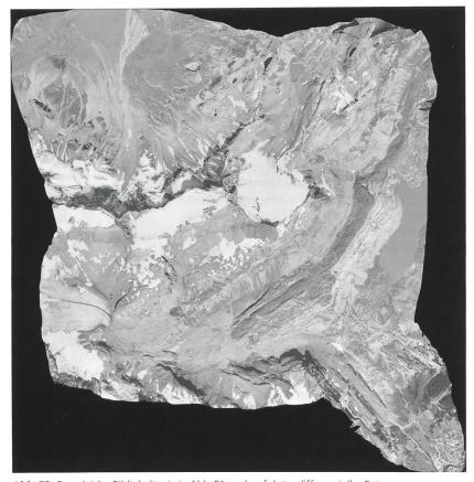
**Abb. 52:** Der gleiche Bildinhalt wie in Abb. 51 nach erfolgter differenzieller Entzerrung (Orthorektifikation). Jedes Bildelement (Pixel) liegt an seiner geometrisch korrekten Lage im Landeskoordinatensystem (swisstopo, Einzelbildorthophoto, Inv. Nr. 000-251-508).
