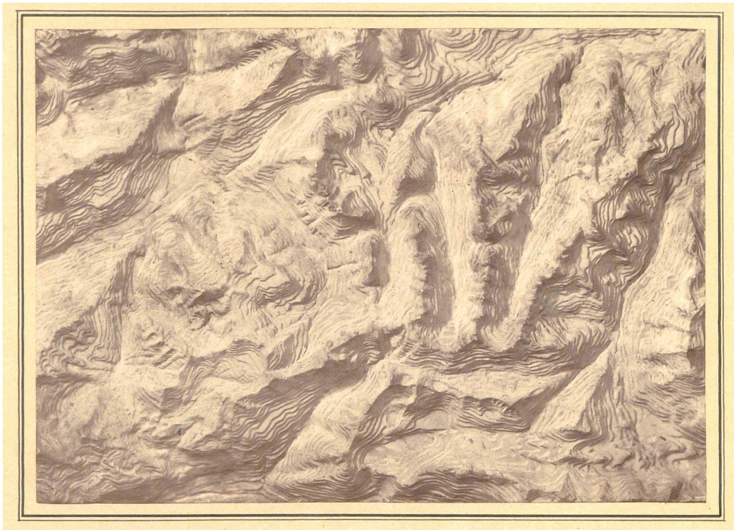
Abb. 7: Photographie von F. Gysi Aarau (Prägestempel unten Mitte), um 1873/1875. Als Grundlage wurde ein von Nordwesten her beleuchtetes Schichtstufenrelief der Gegend zwischen der Göschenalp und Casaccia südöstlich des Lukmanierpasses verwendet. Es ist nicht identisch mit jenem, das der Abb. 6 zugrunde liegt, weil keine Karteninformation zu sehen ist. Abb. auf ca. 25% verkleinert (swisstopo, Kartensammlung).
