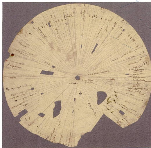
Abb. 57: Richtungsscheibe vom Titlis-Gipfel, die Müller zur graphischen Triangulation diente. Durchmesser: 33 cm (ETH-Bibliothek, Hochschularchiv: Hs 1060, Joachim Eugen Müller).
