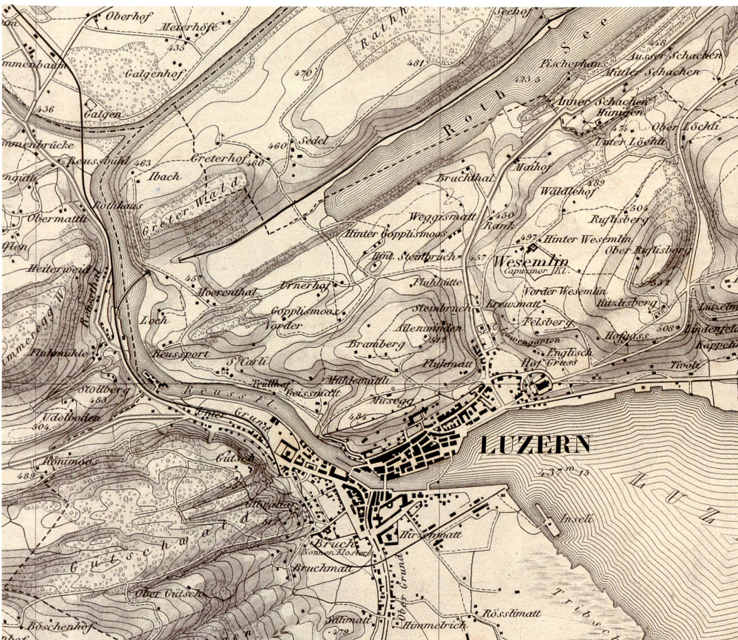
Abb. 81: Topographische Karte des Kantons Luzern 1:25 000, Blatt 6. Ausgabe mit Reliefschattierung, die mit einer Roulette direkt auf der Kupferplatte erzeugt wurde.
