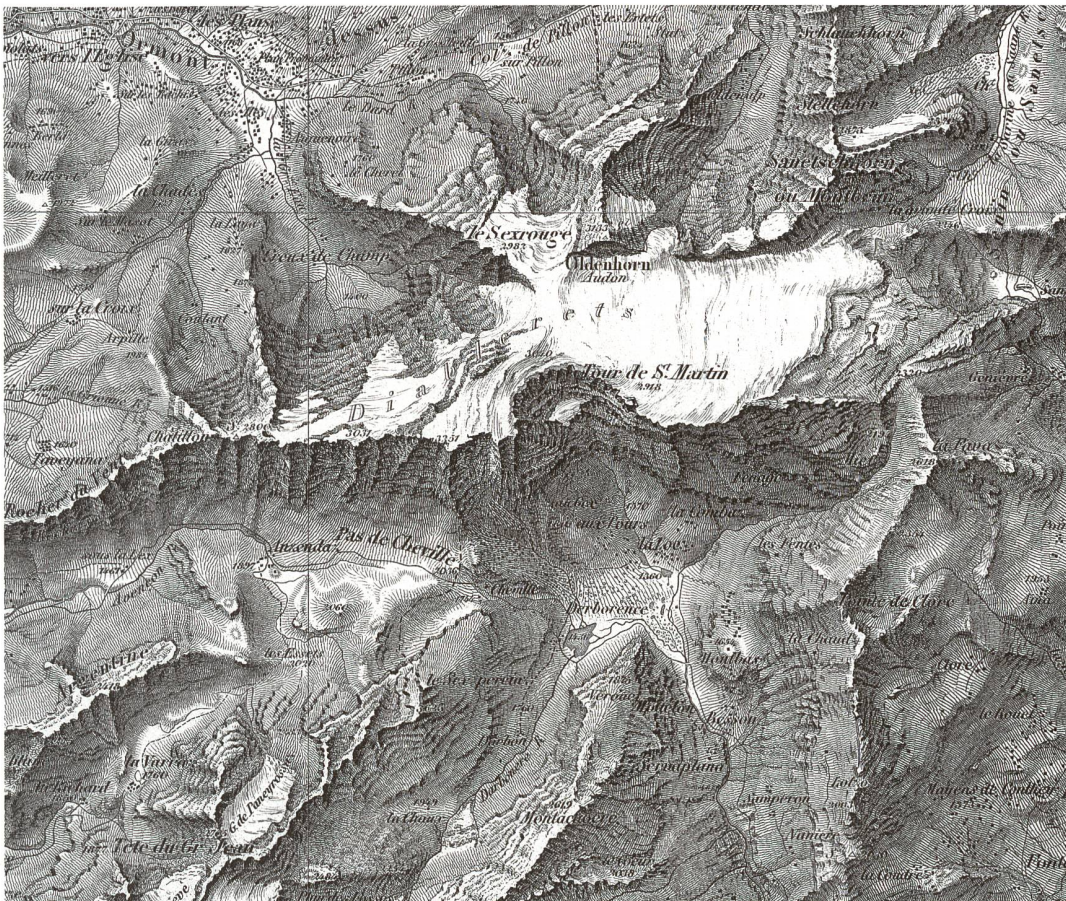
Abb. 47: Musterzeichnung 1:50 000 für Blatt XVII, Subdiv.1. Farbige Tuschezeichnung von Alexandre Stryjenski, vor 1841. Seine Zeichnung erschien als Erstes der vier Blätter und der Inhalt ist fast zu detailliert und etwas unnatürlich wiedergegeben. Die höchste Erhebung des Kantons Freiburg ist mit 2386 m bereits angeschrieben, der Name Vanil Noir aber fehlt noch, wie auch auf der Erstausgabe der Dufourkarte (swisstopo Kartensammlung, TKZ Studien 17 1).
