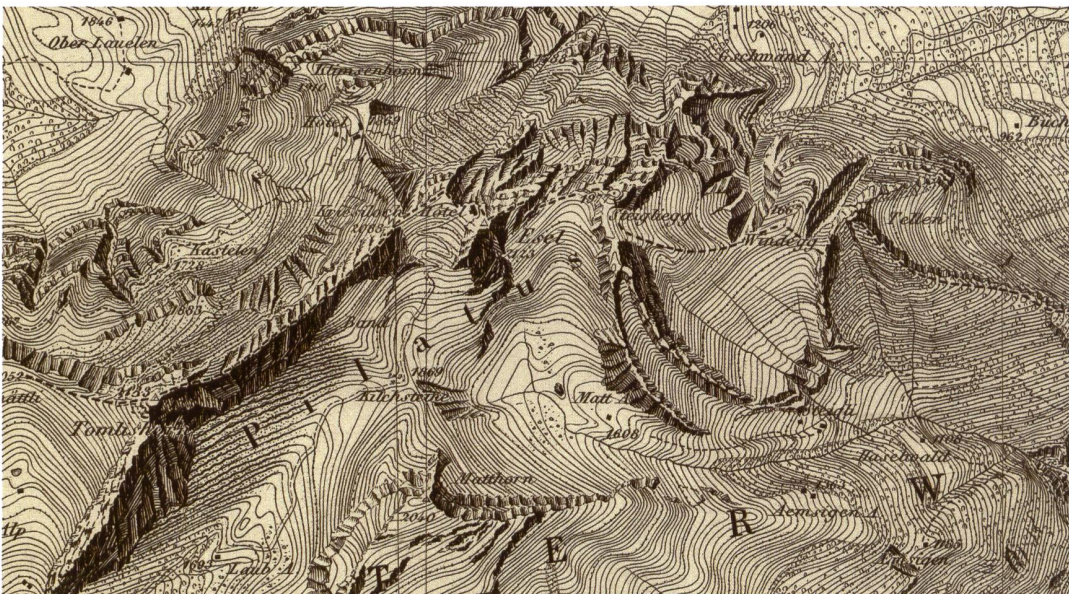
Abb. 35: Topographische Karte des Kantons Luzern 1:25000, 1854–1861 aufgenommen unter Leitung von Ernst Rudolf Mohr. Publiziert 1864–1867: 10 Blätter (einfarbig, 2 Versionen: Höhenkurven resp. Höhenkurven und Relief, Kupferstich von Heinrich Müllhaupt) (swisstopo Kartensammlung, TK LU S8 7).
