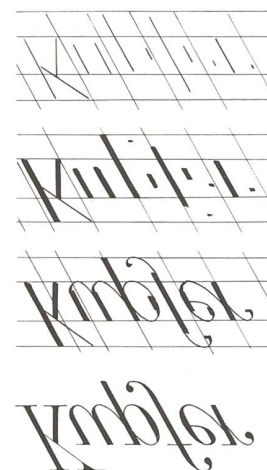
Abb. 54: Beim Kupferstich wird der Karteninhalt seitenverkehrt graviert, so auch bei der Schrift, wo je nach Lage die Platte zudem gedreht wird. Vorher mussten mit Schriftgabeln die Schriftlinien sowie Hilfslinien für die Schriftneigung fein vorgezeichnet werden (vgl. Abb. 27). Zu diesem Zweck mussten die Spitzen der Schriftgabeln rund poliert sein, so dass sie im Kupfer nur glänzende Linien erzeugten.
