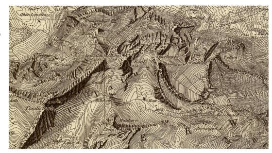
Abb. 36: Topographische Karte des Kantons Luzern 1:25 000; 2. Version, publiziert 1867 mit Höhenkurven und Reliefdarstellung. Die Schummerung wurde auf der Kupferplatte mittels Roulette erzeugt; damit war eine reine Höhenkurvendarstellung nicht mehr möglich (swisstopo Kartensammlung, TK LU S1 7 rel).
