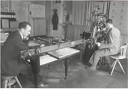
Abb. 36: «Autograph Wild No 3», 1938. Auswertung der terrestrischen Aufnahmen: Der Photogrammeter (rechts) tastet mit der Messmarke im Stereomodell die zu kartierenden Landschaftselemente ab, während der Ingenieur-Topograph (links) den Zeichenstift bedient und die topographischen Details ergänzt (swisstopo, Bildsammlung, Technische Aufnahme 5363b).
