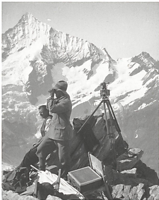
Abb.35: Terrestrische Aufnahme mit dem Phototheodolit Wild (Abb. 38) auf der Station Plattenhorn im Jahre 1930, im Hintergrund das Weisshorn (swisstopo, Bildsammlung, Technische Aufnahme 4506).
