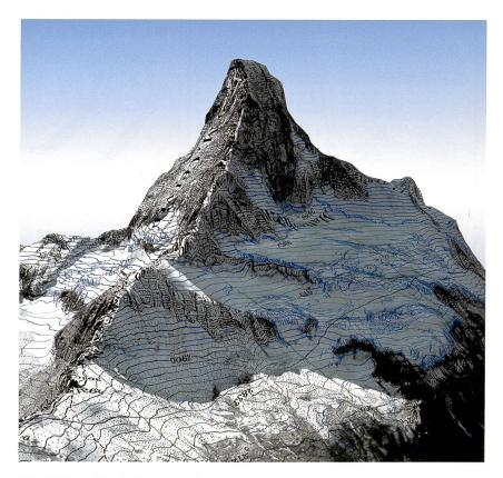
**Abb. 85:** Perspektivische Darstellung des Matterhorns, erzeugt aus einem digitalen Höhenmodell, kombiniert mit Textur aus der digitalen Landeskarte der Schweiz 1:25000 und einem Orthophoto (Daten von swisstopo, Visualisierung ETH Zürich 2002).
