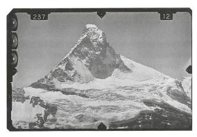
Als Dritter kam Ingenieur Bähler **(Abb. 69)** nochmals zum Zug, nun aber nicht mehr als Trigonometer, sondern als Photogrammeter. 1924 war bei der Landestopographie die terrestrische Photogrammetrie für die topographische Vermessung des Alpengebietes eingeführt worden. Mit der Beschaffung von vier Phototheodoliten und zwei Stereoauswertegeräten der Firma Wild Heerbrugg war man auch instrumentell gut ausgerüstet – die klassische Messtischtopographie erhielt massive Konkurrenz.
