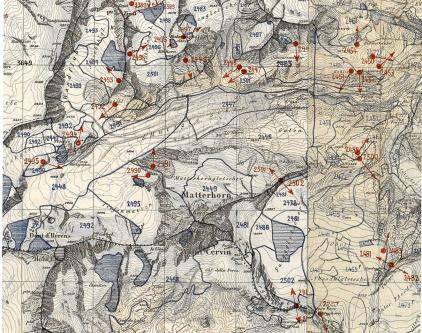
Abb. 70: Übersicht über die Disposition der terrestrischen Aufnahmen des Matterhorns durch Ingenieur Bähler. Die vier Gipfelflanken wurden von den Stationen 2449 (16.7.1930), 2481 (30.8.), 2488 (4.9.) und 2495 (19.9.1930) aus fotografiert (swisstopo, Bildsammlung, Zusammensetzung der TerrA-Übersichten 531 und 535).
