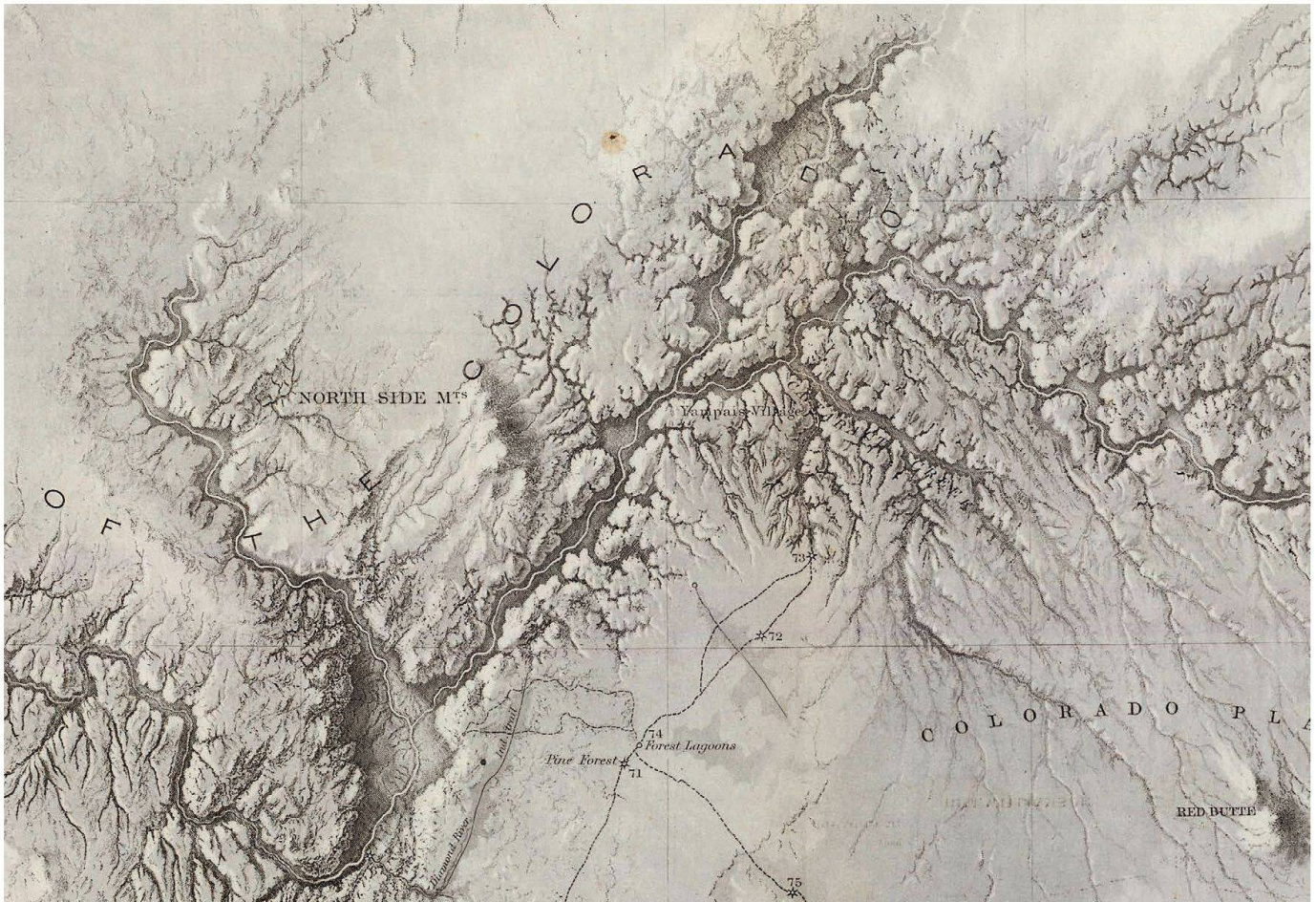
Abb. 11: Ausschnitt der Rio Colorado of the West, Map No. 2 (schwarz-weiße Variante) im Maßstab 1:760 320 (1 Inch = 12 Miles) mit der ersten aufnahmestützten Kartierung des Grand Canyon, mit Einzeichnung der Route der Ives-Expedition auf dem südlichen Hochplateau (Quelle: Ives 1861, Map No. 2; www.davidrumsey.com Image No. 0341.002).
