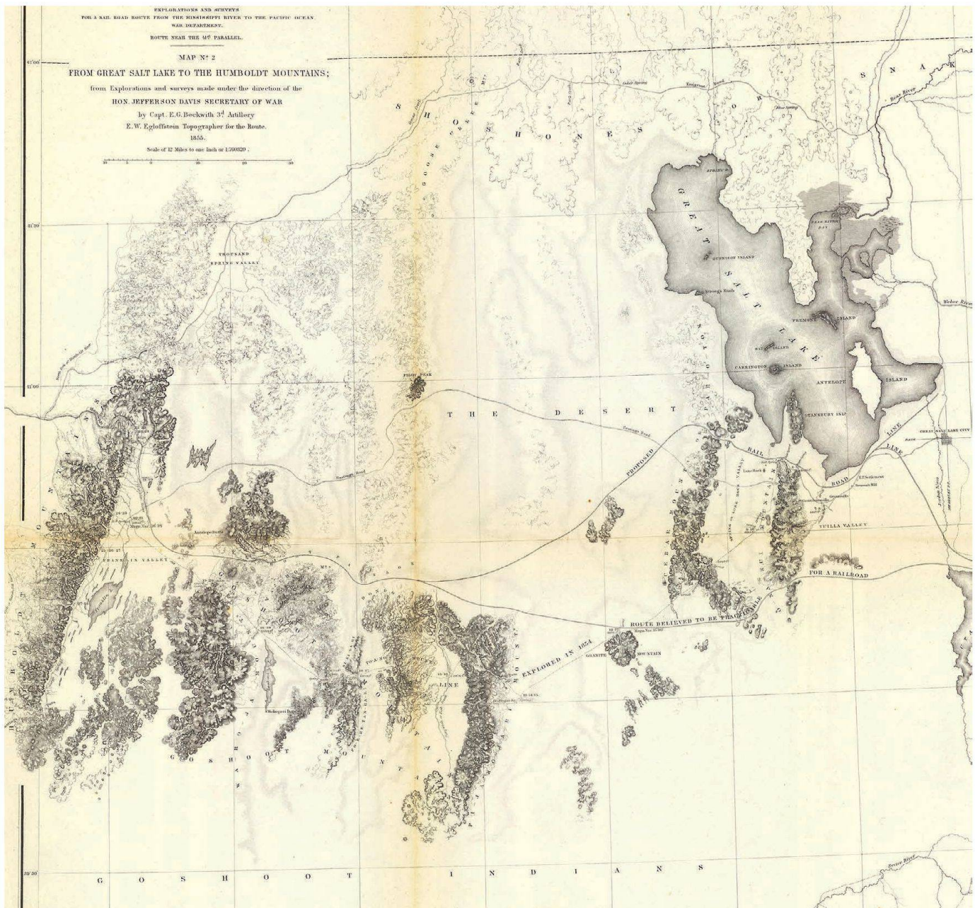
Abb. 4: Ausschnitt des Kartenblatts Map 2: From Great Salt Lake to the Humboldt Mountains der Beckwith-Expedition im Massstab 1:760 320 (1 Inch = 12 Miles) mit den begangenen Routen in gestrichelter Linie und der vorgeschlagenen Eisenbahntrasse in Doppellinie (Quelle: Beckwith 1855b: Map No. 2; www.davidrumsey.com Image No. 0693.029).
