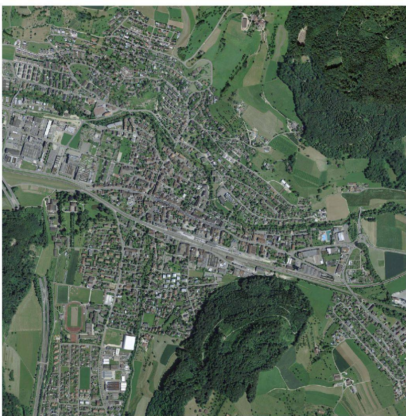
Abb. 14: Ältestes swisstopo-Luftbild von Sissach: Aufnahme 719 vom 13. Mai 1931 mit der Wild-Messkammer 17 mit einer Brennweite von 165 mm aus einer Flughöhe von 3050 m. Der Abstand der Rahmenmarken auf der Glasplatte beträgt 13 x 13 cm. Der Vergleich mit der streng nach Norden ausgerichteten Abb. 15 zeigt, dass die vermutlich freihändig gehaltene Kamera im Zeitpunkt der Aufnahme leicht nach Osten verdreht war.
