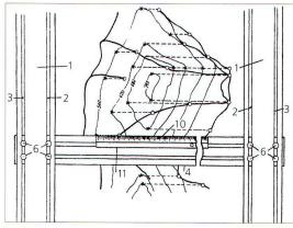
Abb. 4: Pantographic map drawing apparatus der Firma Coradi. Oben schematisch mit Höhenlinien für einen Kegel und unten zwei Ansichten aus dem US-Patent. Die Originalkarte ist jeweils rechts und die umprojizierte Karte links angeordnet.
