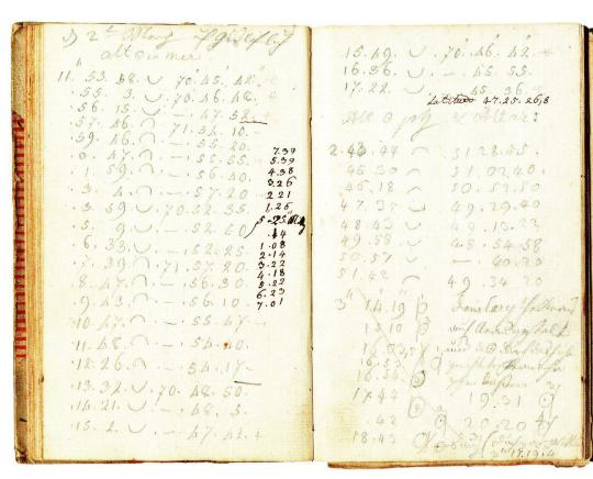
Abb. 4: Typischer Ausschnitt aus Hasslers Feldbuch, mit der Beobachtung der Sonnenhöhe auf der Gislifluh vom 2. März 1797. <sup>29</sup> Im rechten unteren Teil bemerkt Hassler Den Caryschen Kreis auf Arau gestelt und die [Sonne] durch das höher gerichtete Fernrohr scheinen lassen. Vgl. Abb. 7 und Tabelle 1 (Schweizerisches Bundesarchiv BAR, E 27/22115).
