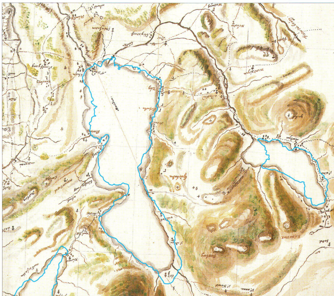
Abb. 4: Ausschnitt aus der in die Landeskordinaten umgerechneten und nach Norden gedrehten Karte des Kantons Zug mit den überlagerten Konturen des Zuger- und Ägerisees aus der aktuellen Landeskarte. Man beachte den für Pfyffer typischen Darstellungsfehler am Nordwestende des Ägerisees (Entwurf: Jana Niederöst).
